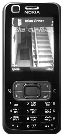
Другим примером дальнейшего наращивания функциональности является система удаленного мониторинга «Орион Mobile». Данная система позволяет оценить обстановку на охраняемых объектах с мобильного телефона. Система позволяет подключаться к установленным видеокамерам и просматривать видеоархив с помощью сотового телефона с поддержкой технологии Java. До сентября 2009 года, на время проведения публичного тестирования, любой пользователь ИСО «Орион» может оценить удобство
